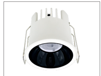
블랙 & 화이트 68 LAMP 12W SIZE 74x68 CUT SIZE 68 BEAM ANGLE 24°
