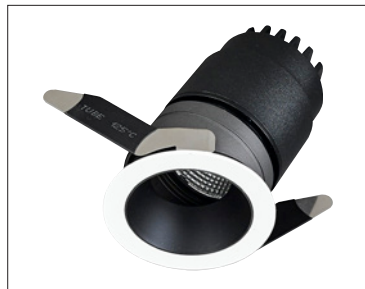
스카이 60-B형 LAMP 10W,15W,20W SIZE 68 X H95/133 CUT SIZE 60 BEAM ANGLE 24°, 36°, 50°
